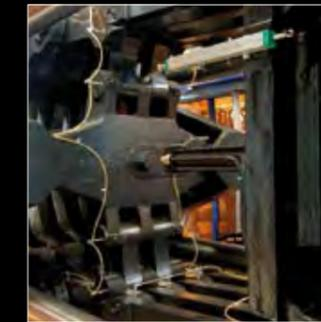
La regolazione della forza di chiusura avviene con trasduttore di forza ad alta precisione, inoltre la tensione massima delle colonne è controllata da allarme.
