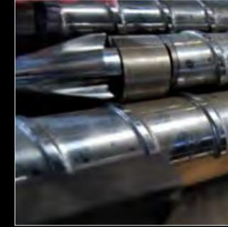
Unità di plastificazione con rapporto fino a L/D 25 e pressioni specifiche sino a 2.500 Bar. L'omogeneizzazione del polimero è garantita con viti dotate di speciali sezioni di miscelazione e lavorazione.
