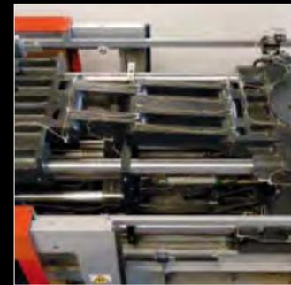
La serie IMPETUS HS è equipaggiata con un gruppo di chiusura a ginocchia a cinque punti, di nuovo progetto, per incrementarne le caratteristiche dinamiche. Il piano mobile è supportato con robuste guide lineari ad alta precisione per assicurare il perfetto parallelismo dei piani durante il ciclo produttivo e ridurre al minimo gli attriti.
