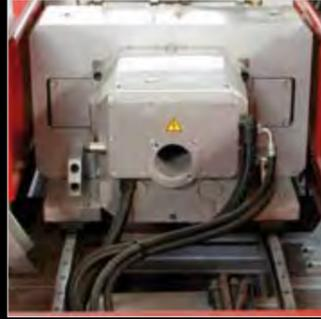
Il motore elettrico di serie è progettato per applicazioni che richiedono alta velocità di plastificazione e per ridurre il tempo ciclo in caso di materiali ad alta viscosità; è inoltre possibile ottimizzare i consumi energetici mediante la gestione di inverter.
