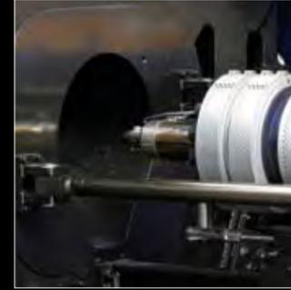
Il gruppo iniezione è attrezzato con sistema di cambio rapido vite e cilindro, con conseguente possibilità di sostituire agevolmente il cambio del gruppo di plastificazione.
